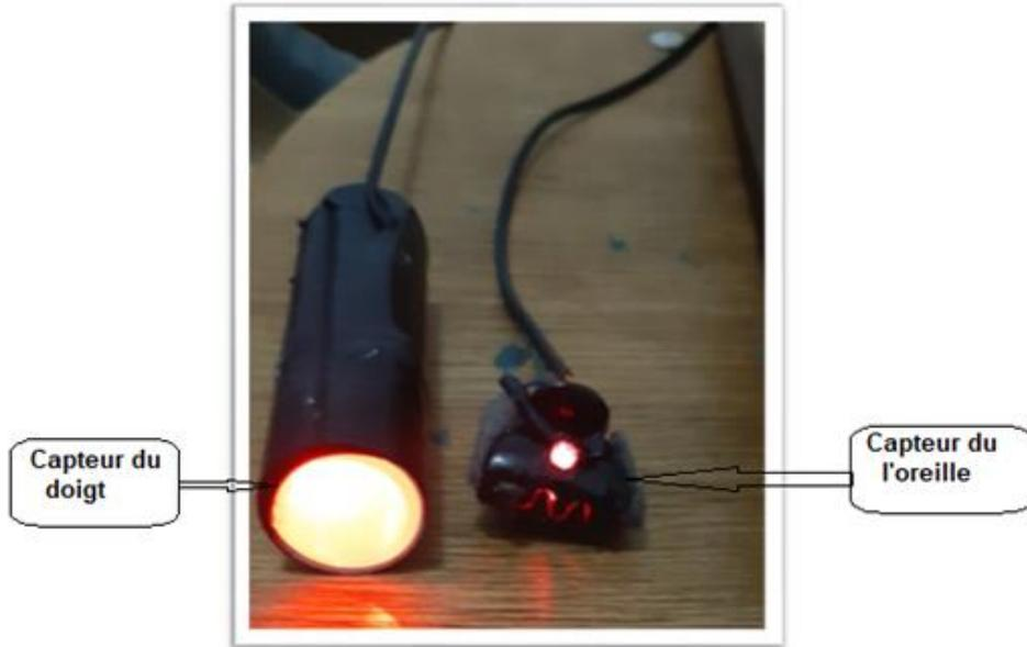
Figure 3.2. Les capteurs réalisés.
