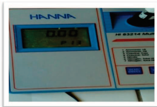
Photo14 : Spectrophotomètre pour mesurer les phosphates.
