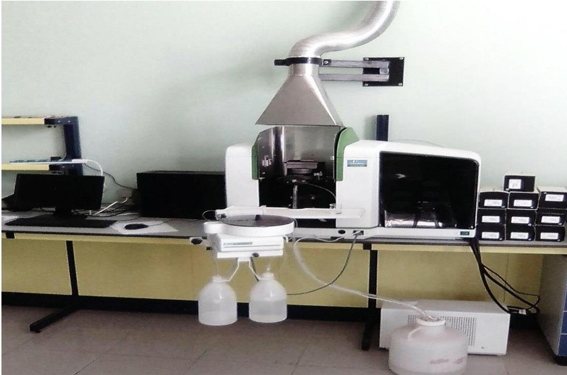
**Fig. II.3 :** Appareil de spectrométrie d'absorption atomique du laboratoire Toxicomed.
