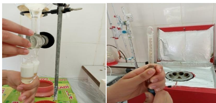
Figure 30 : Préparation des échantillons et la lecture de résultat sur le butyromètre ( photo originale )
