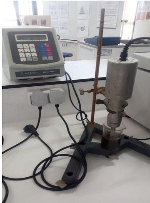
Figure 14 :l'appareil d'ultrasons (sonicateur)
