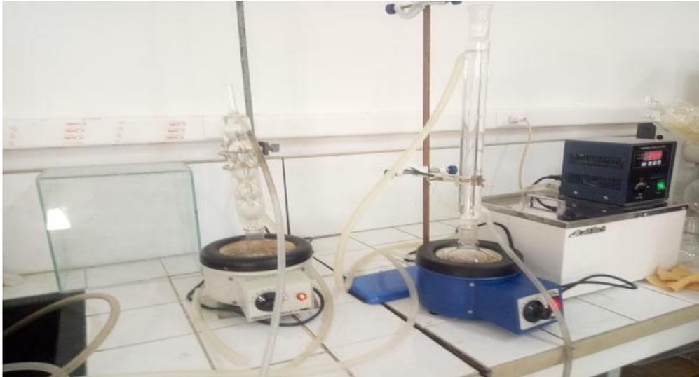
**Figure 13 :** L'appareil de décoction
