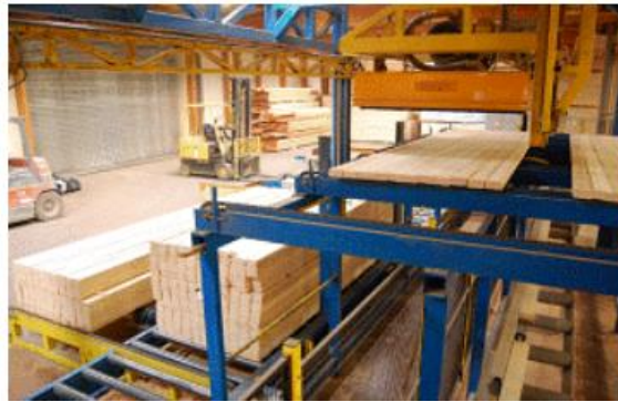
Figure 19: Phase de dépilage en usine.
