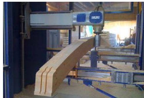
Figure 31: poutre fini et prête.
