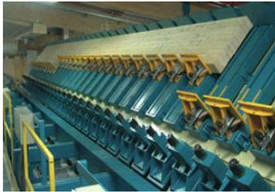
Figure 28: Opération serrage sous pression.
