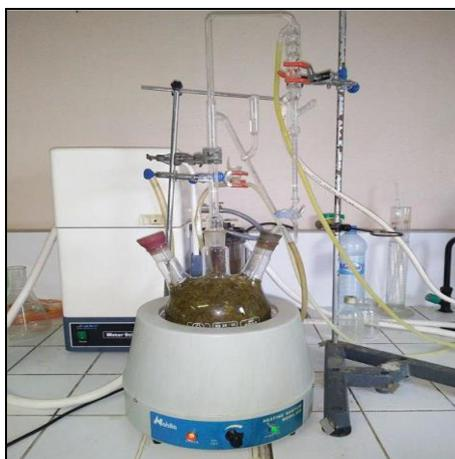
**Photo 7 : Montage d'un appareil d'hydrodistillation de type Clevenger**
