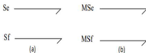
FIGURE I.12 – Éléments actifs.(a) :Sources d'effort et flux. (b) :Sources
