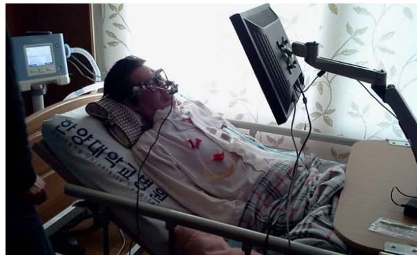
FIGURE I.22 – IHM Samsung avec une souris commandée par l'eye tracker pour les personnes handicapés moteurs [18].
