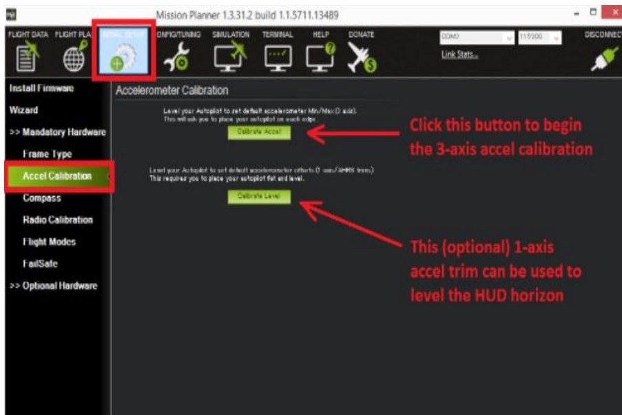
FIG. 2.14 : Étalonnage de l'accéléromètre [1]
