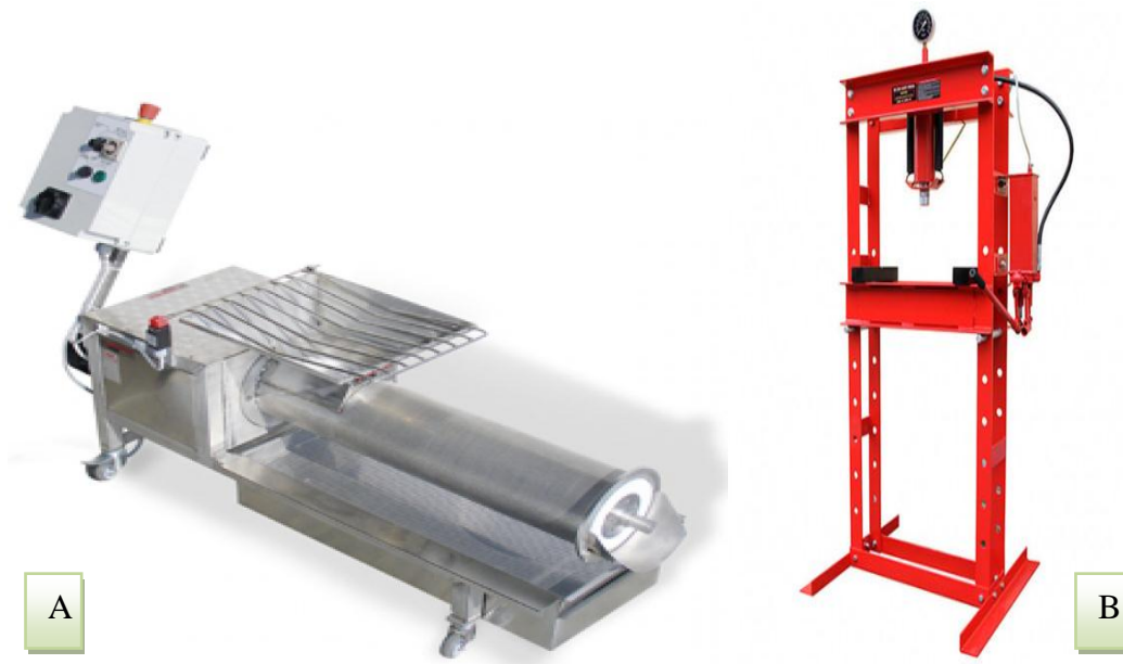
Figure 18: Presse à vis pour le pressage des oléagineux ( A ) (source La mécanique moderne) et Presse hydraulique pour le chocolat ( B ) (source Barry-Callebaut) ( Savoire, 2008 ).
