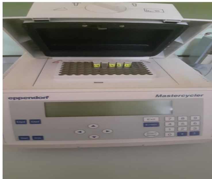
Figure07: l'appareil de la PCR (thermocycleur).
