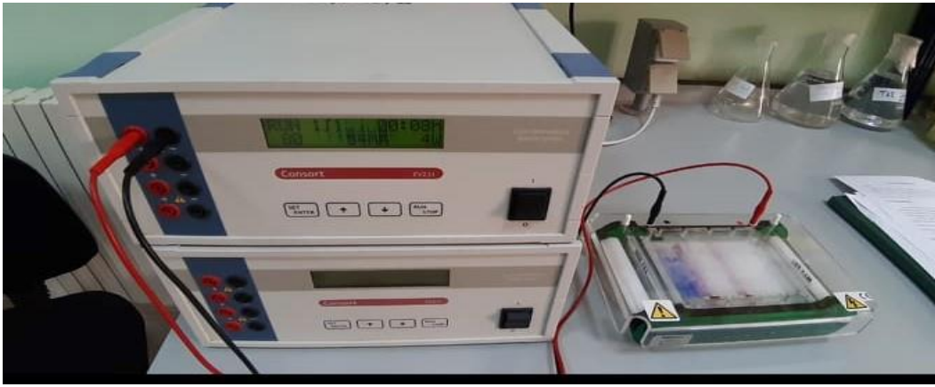
Figure 08 : cuve d'électrophorèse horizontale remplie en gel
