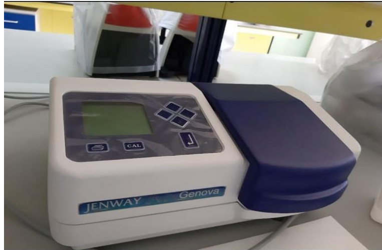
Figure 06 : l'appareil de dosage (spectrophotométrie).
