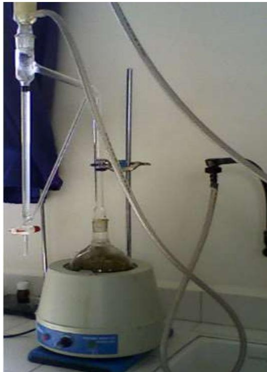
**Figure 5.** Montage d'un hydrodistillateur type Clevenger. ( **ALAOUI BOUKHRIS, 2009** )
