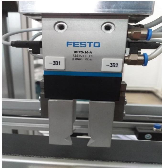
**Figure 34 :** Capteur électromagnétique 3B1/ 3B2
