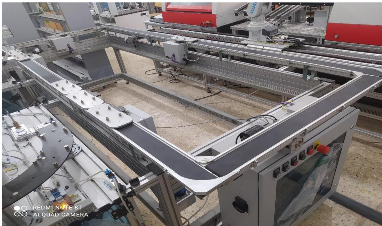
**Figure 6 :** Station de convoyage (Convoyeur à Palettes)
