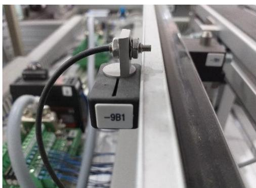
**Figure 16 : Capteur optique à barrage 9B1**
