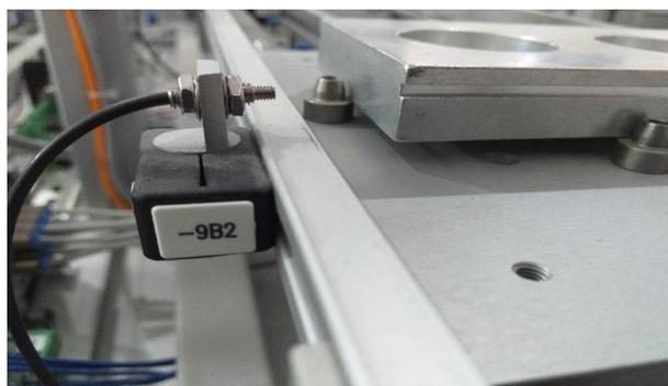
**Figure 17 : Capteur optique à barrage 9B2**
