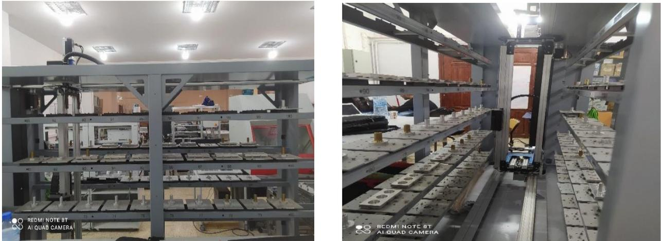
**Figure 4-5 :** Station de stockage/déstockage automatique AS/RS
