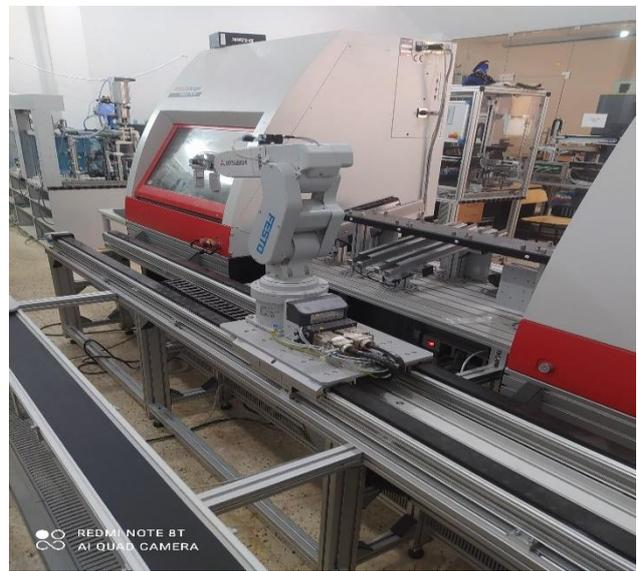
Figure 7-8 : Machine de fraisage 105 avec robot d'alimentation flexible
