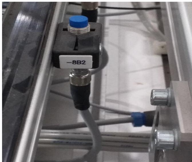
**Figure 19 :** Capteur inductif 8B2
