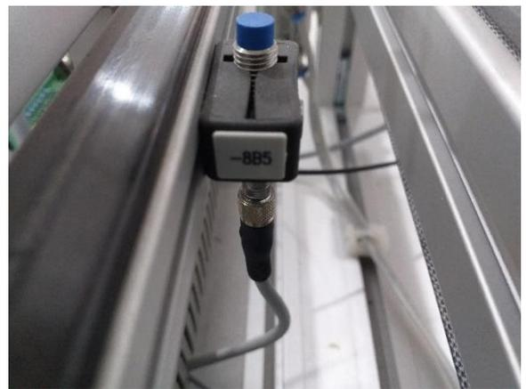
**Figure 20-21 :** Capteur inductif 8B3-8B5
