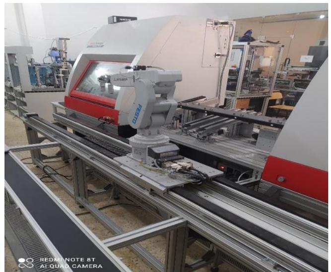
Figure 9-10 : Machine de tours 105 avec robot d'alimentation flexible
