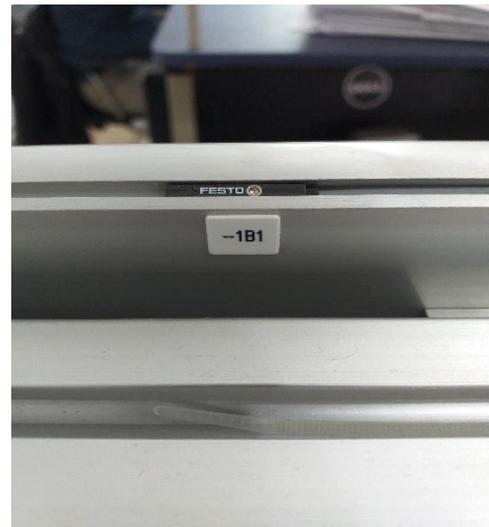
**Figure 31-32 :** Capteur électromagnétique 1B2 / 1B1
