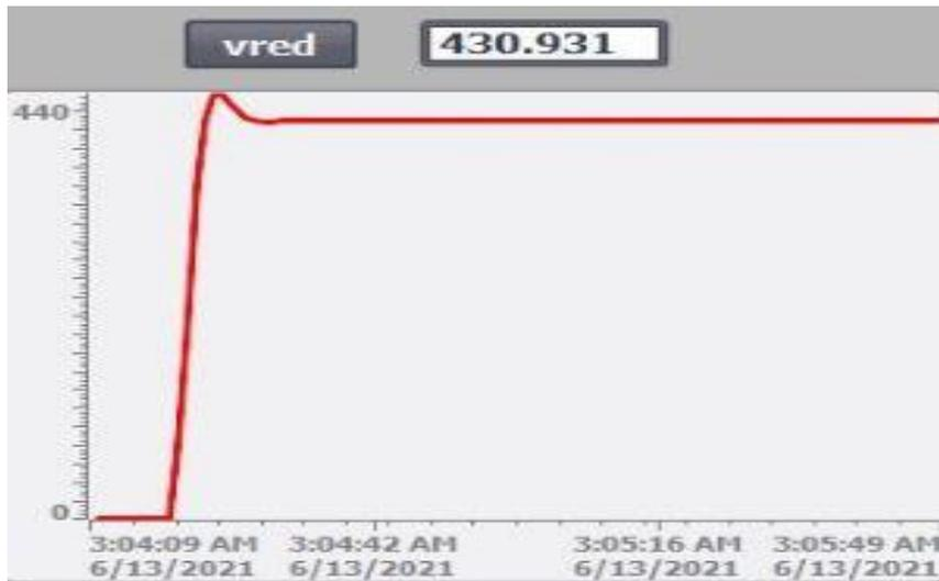
Figure III. 60 : Evolution de la variable vitesse réduite obtenu au niveau d'API.
