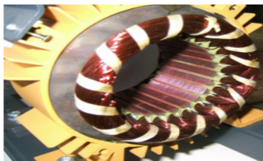
FIGURE 2.1 – Stator d'un moteur asynchrone [15]
