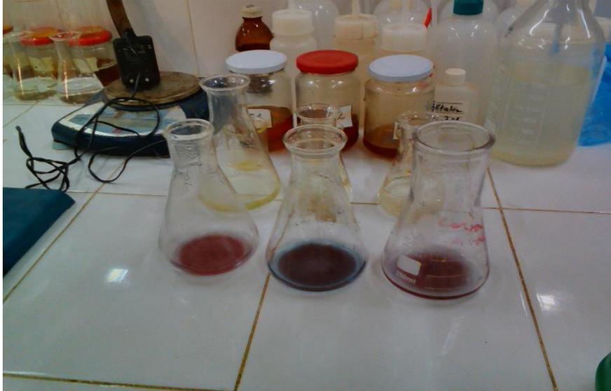
**Photo 14** - Echantillon pour la détermination des sucres réducteurs totaux
