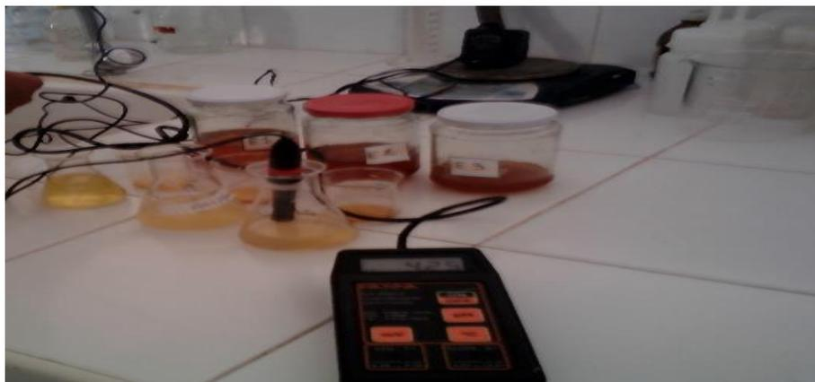
**Photo 7** - Le pH-mètre avec solution du miel (MECHERNENE, 2021)
