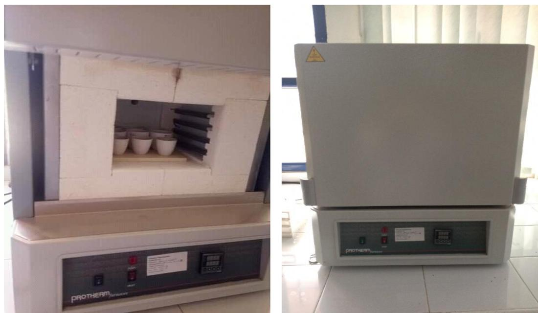
**Photo 8** - Prises d'essai de taux des cendres dans le four
