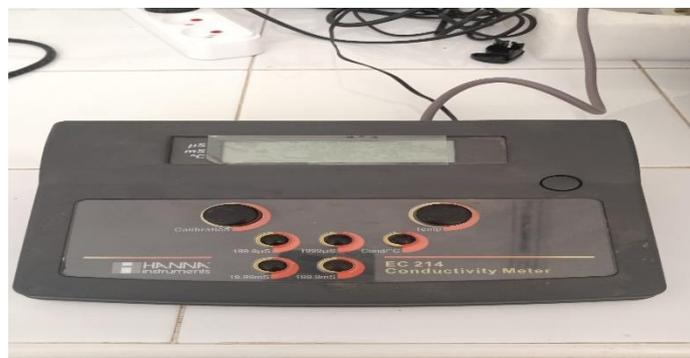
**Photo 4** - Le conductimètre (MECHERNENE, 2021)
