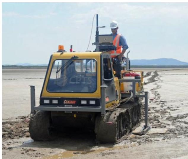
Figure II.10 : Mise en service du pénétromètre CPT
