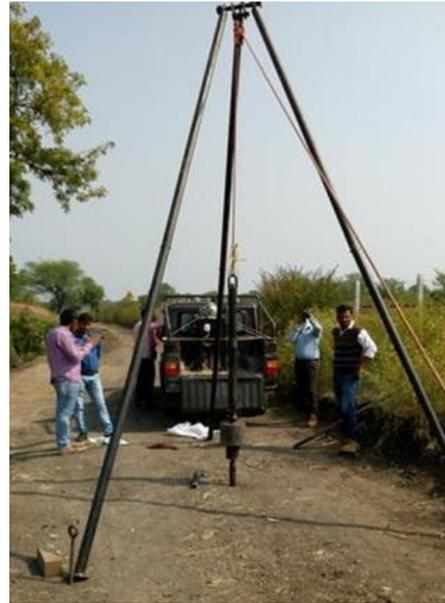
**Figure II.4** : mise en service du pénétromètre SPT
