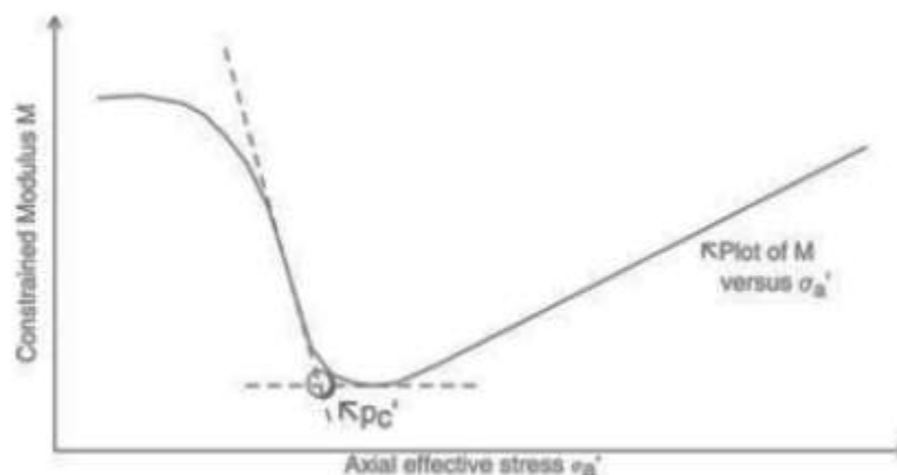
Fig Annexe 2. 6 : Première variante de la méthode de Janbu pour déterminer la pression de préconsolidation (Lunne et al. 2008)
