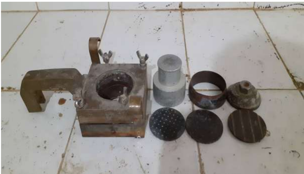
Fig 4. 6 : Boite de cisaillement démontée avec le moule et le calibre de découpage (Lae)
