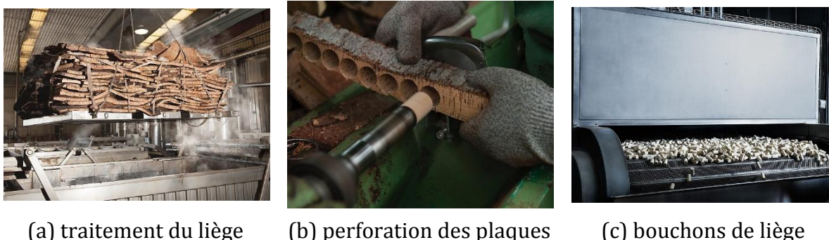
Figure 2.10. Fabrication des bouchons de liège (Source : Amorimcork.com).
