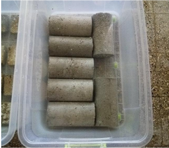
Figure 3.14. Conservation des éprouvettes de béton de liège.
