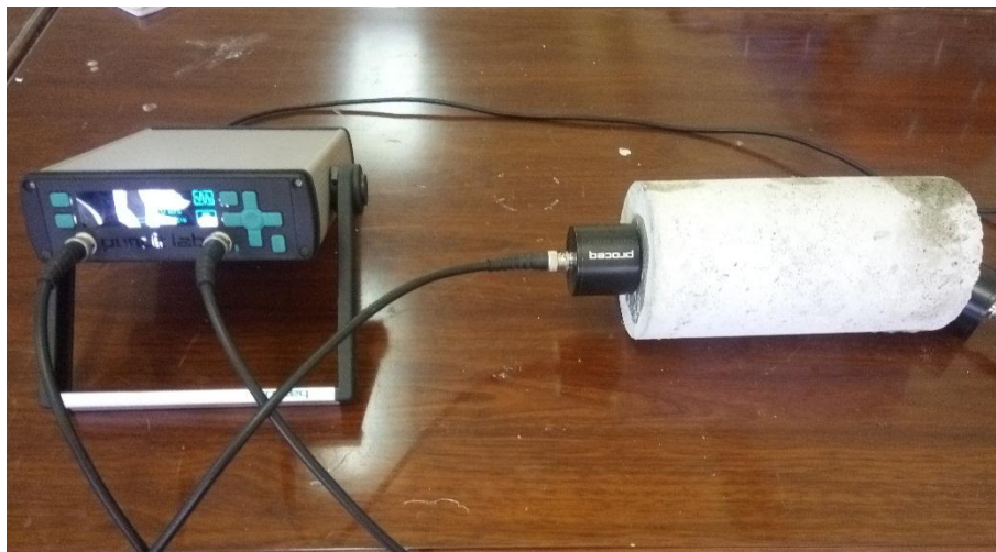
Figure 3.16. Mesure de la vitesse ultrasonore.
