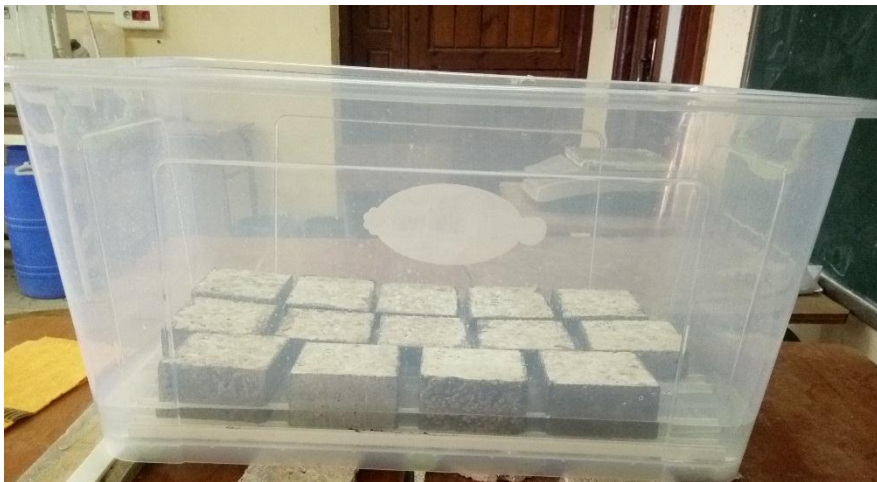
Figure 3.25. Mesure expérimentale de la capillarité.
