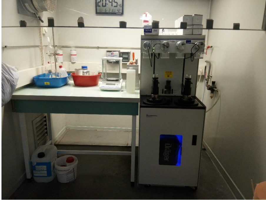
Figure 3.27. Dispositif de mesure de la porosité au mercure (Laboratoire LaSIE, La Rochelle Université).
