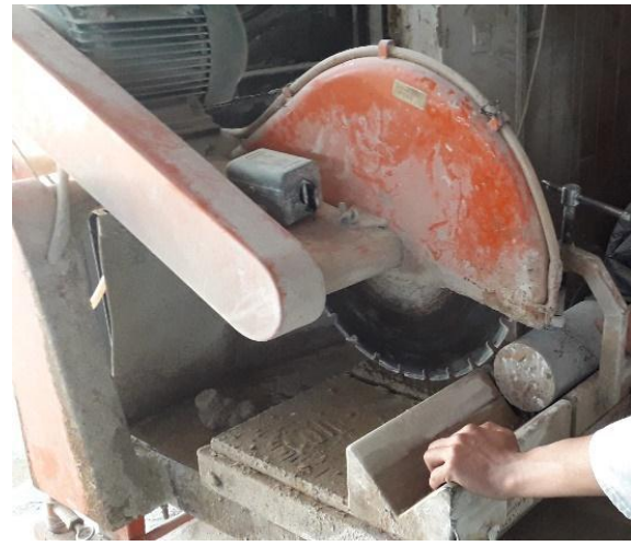
Figure 3.15. Surfaçage des éprouvettes de béton de liège.
