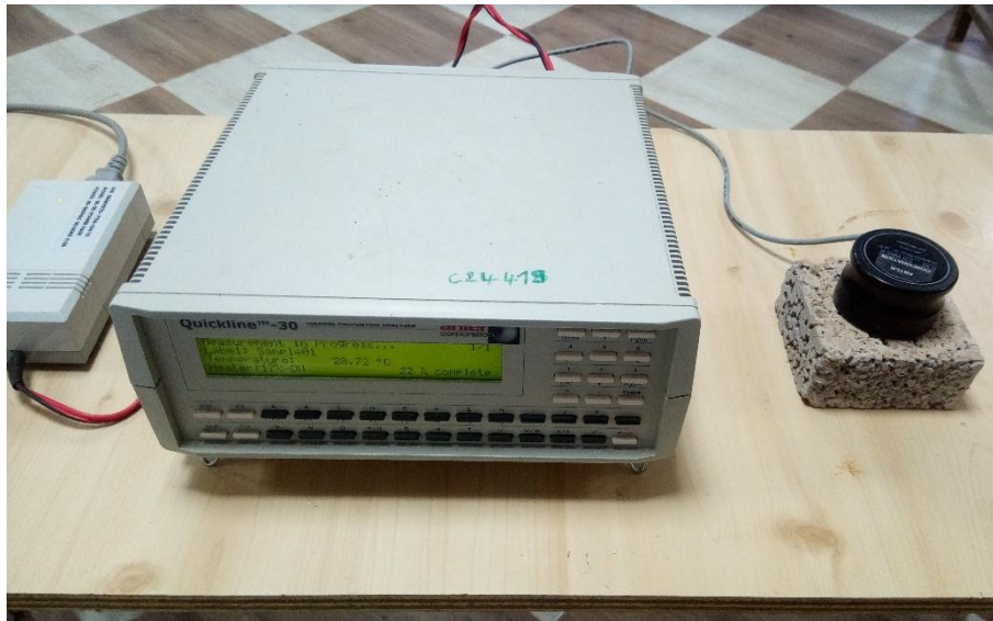
Figure 3.17. Mesure de la conductivité thermique à l'aide du QUICKLINE-30 (Laboratoire LABMAT, Ecole Nationale Polytechnique d'Oran).
