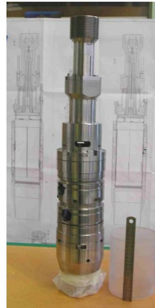
Figure 2.34 : Essai triaxial in situ : brevet LCPC (Reiffsteck, 2004).
