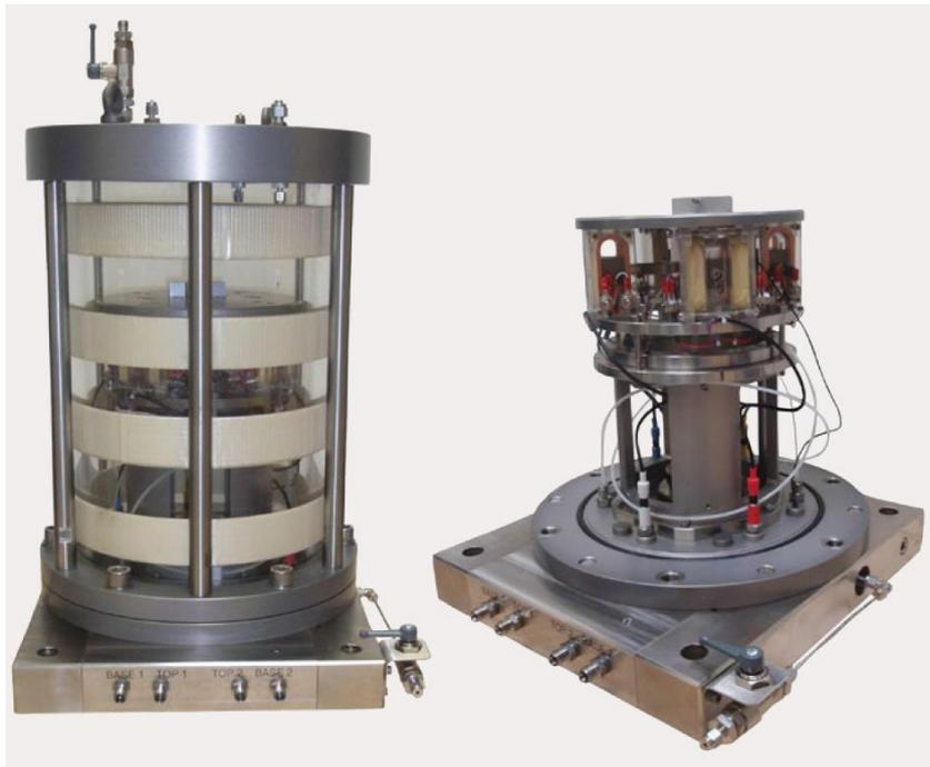
**Figure 2.46 : Essai à la colonne résonante.**
