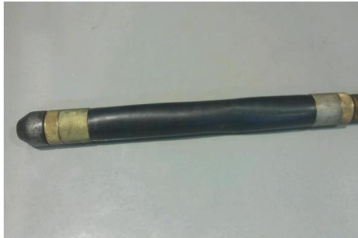
**Figure 3.8 : La sonde assemblée avec la membrane.**
