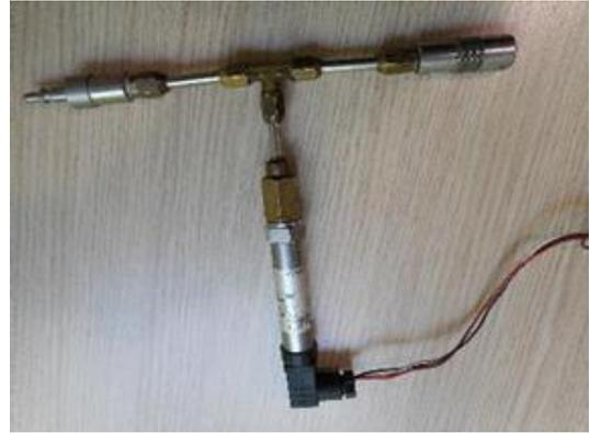
**Figure 3.23 : Raccordement de capteur de pression.**
