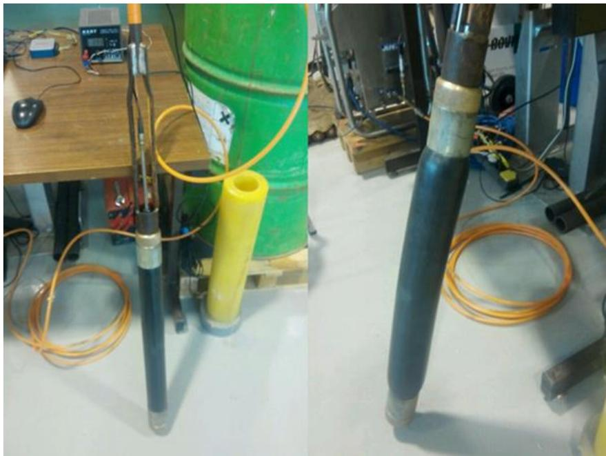
**Figure 4.8 : Photo de la sonde pressiométrique pendant la phase d'étalonnage.**
