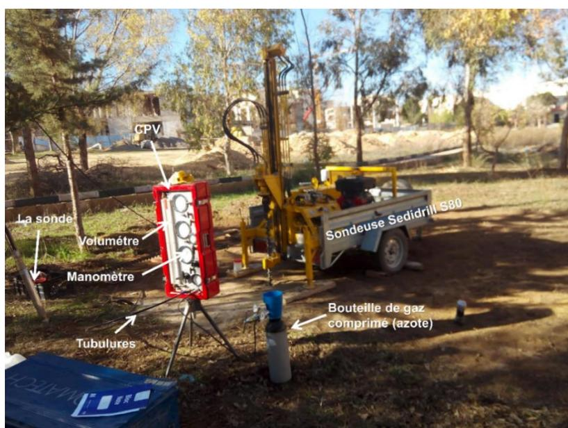
**Figure 4.51 : Matériel pressiométrique Ménard classique utilisé pour le site de Tlemcen**
