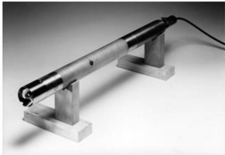
**Figure 3.3 : Pressiomètre autoforeur Cambridge in situ.**
