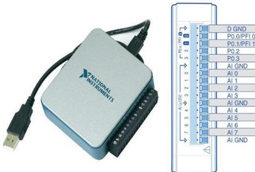
**Figure 3.11 : Boîtier d'acquisition de données USB-6000.**
