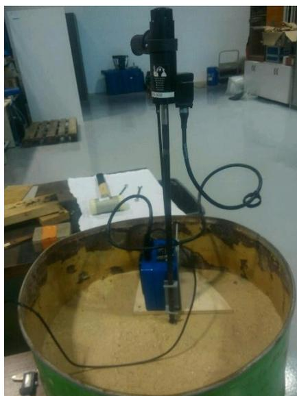
**Figure 4.4 : Essai PANDA 3® dans la cuve de sable.**
