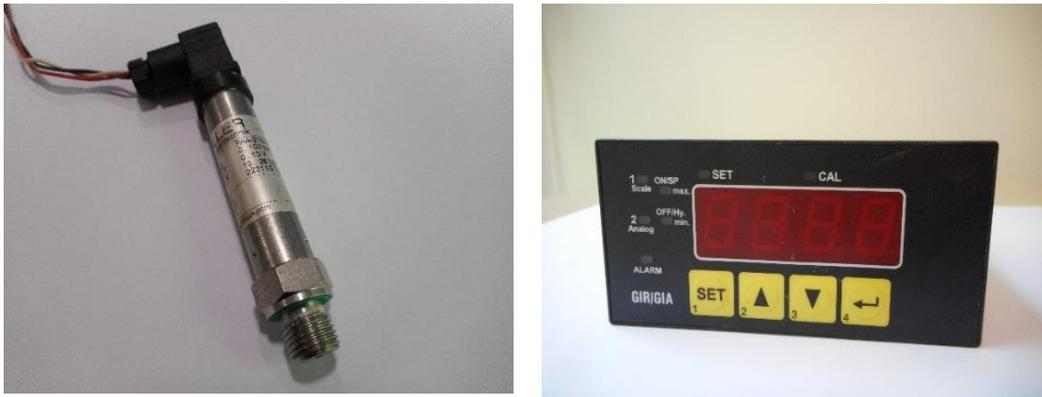
**Figure 3.22 : Capteur de pression KELLER utilisé et régulateur numérique EV-6.**
