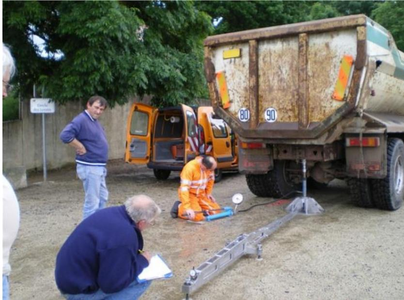
**Figure 2.23 : Essai de chargement à la plaque (Monnet, 2015).**
