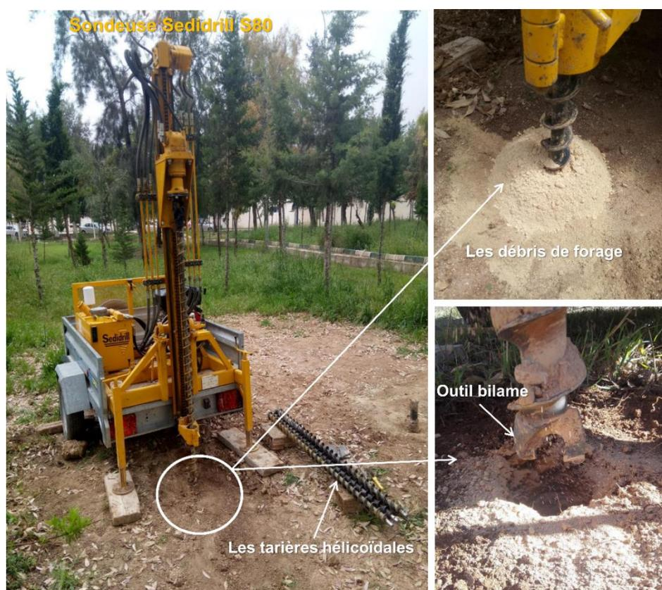
**Figure 4.43 : Machine de forage employée dans le cadre des expériences géotechniques in situ**
