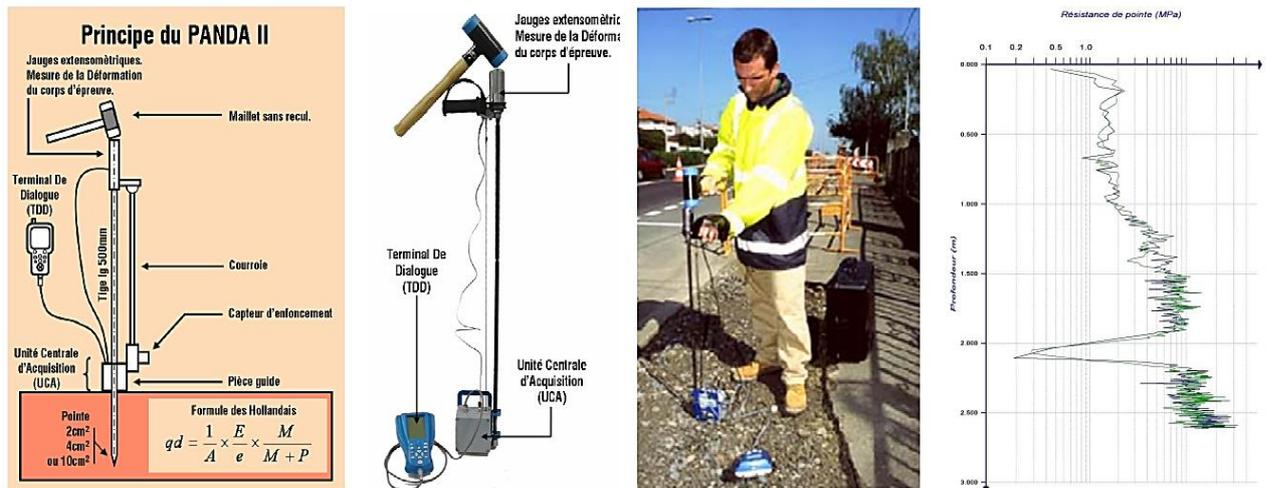
**Figure 2.20 : Principe du pénétromètre dynamique PANDA et exemples de pénétogrammes obtenus (Benz-Navarrete, 2009).**
