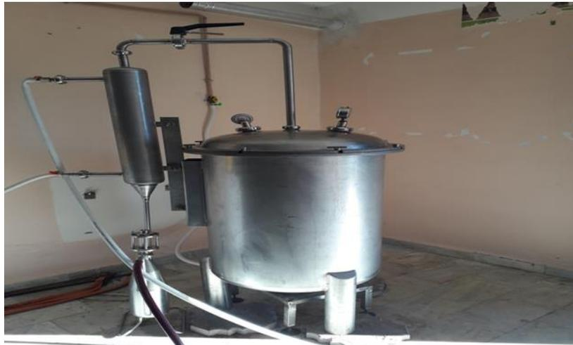
**photo 09** : La distillation à la vapeur d'eau. (photo réelle 2021)
