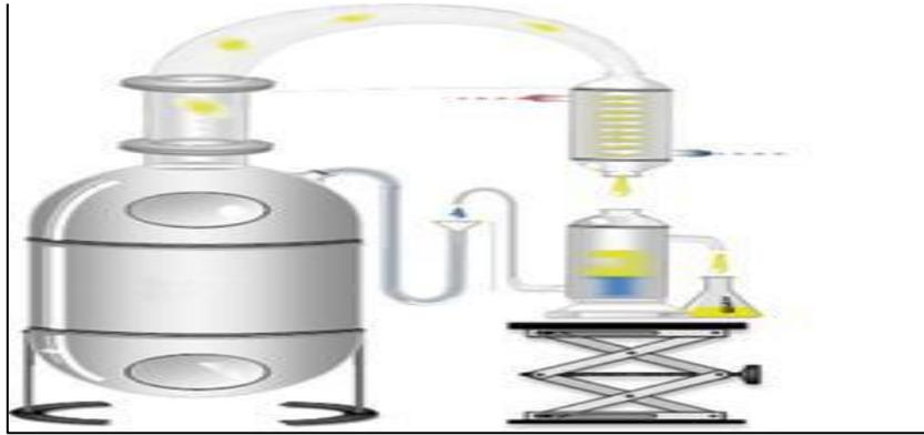
**Figure 06** : description schématique de la technique d'extraction à la vapeur d'eau
