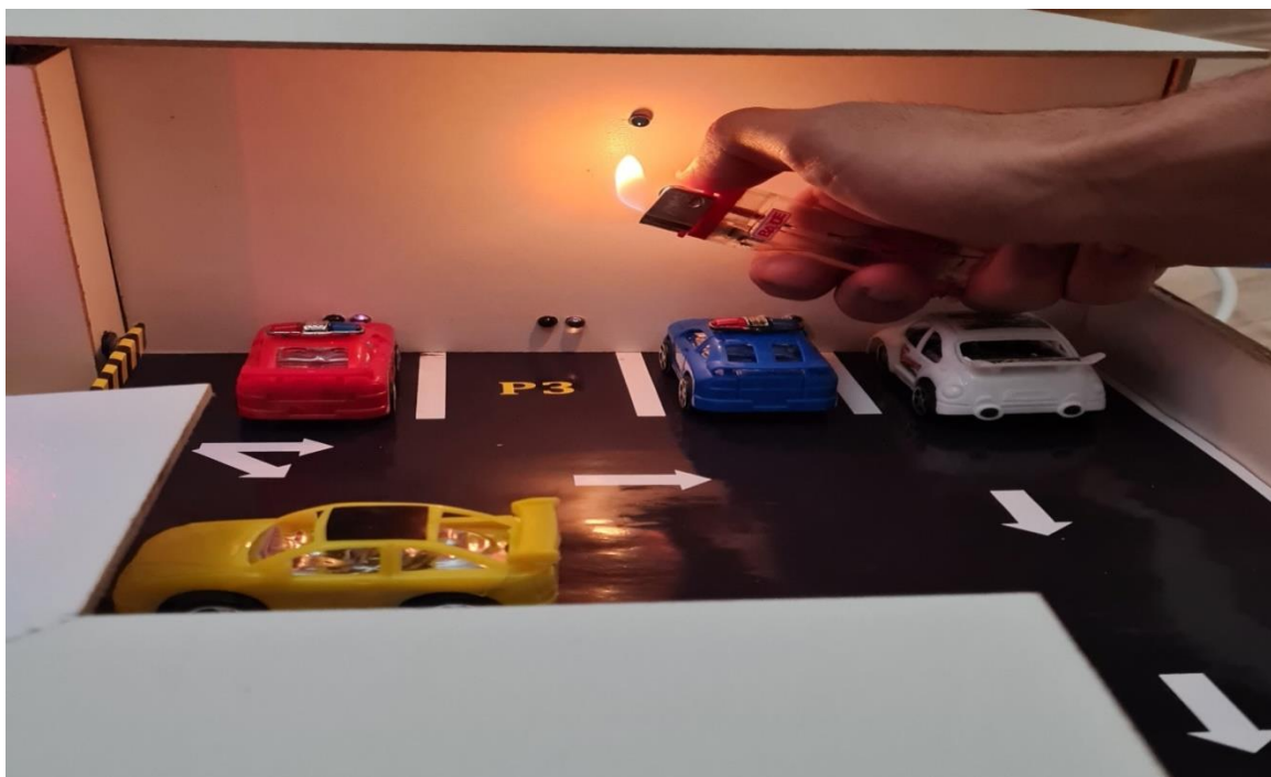
Figure III. 24 : La détection d'incendie.
