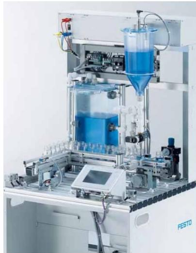
Figure 2.5 : station de remplissage
