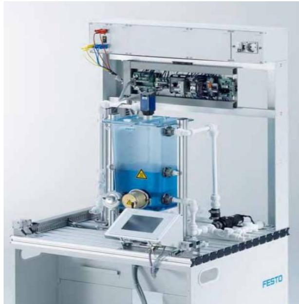
Figure 2.4 : station de réacteur [12]
