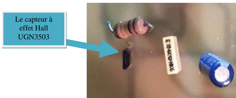
Image III-2 : Présentation du détecteur de champ magnétique sous circuit imprimé.
