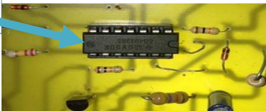
Image III-4 : Schéma électrique du circuit inverseur CD4093 sous circuit imprimé.
