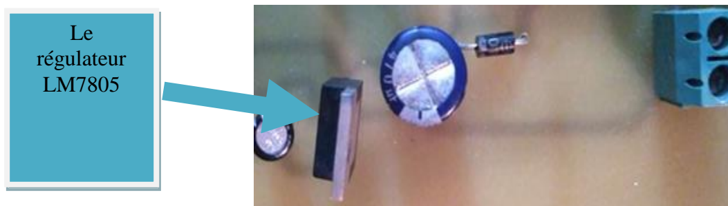
Image III-1 : Présentation de l'alimentation sous circuit imprimé.
