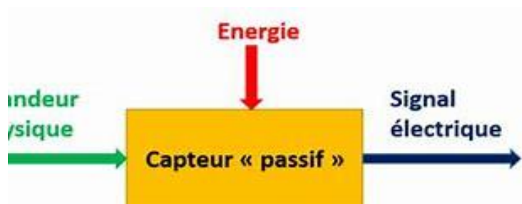
Figure II-6 : Schéma de principe d'un capteur passif.
