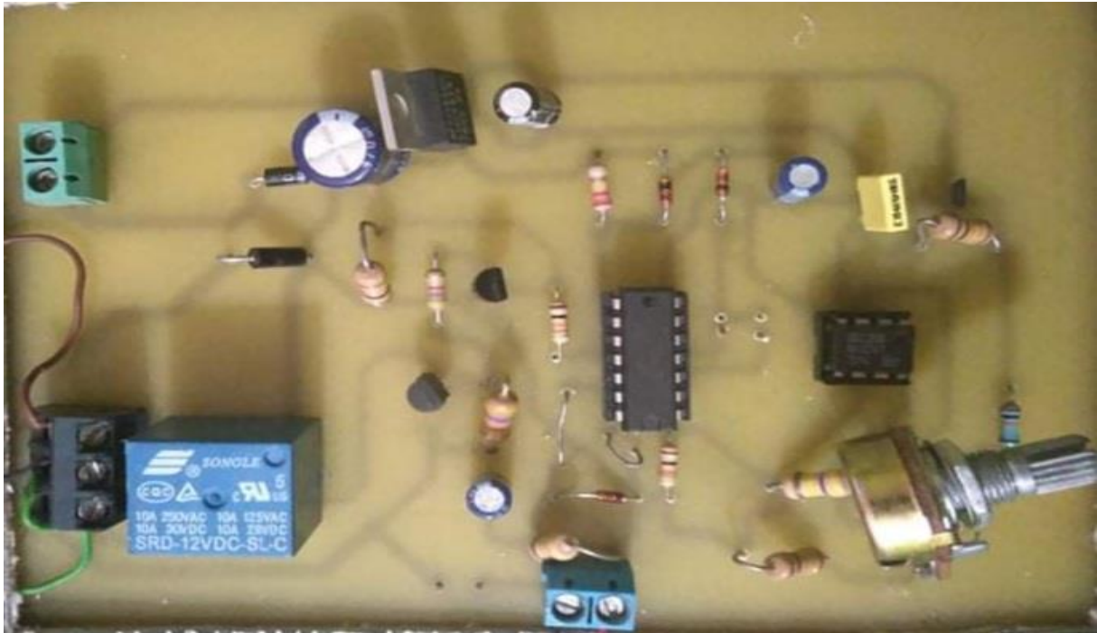
Image III-8 : Photo de la face avant de circuit imprimé après insertion.
