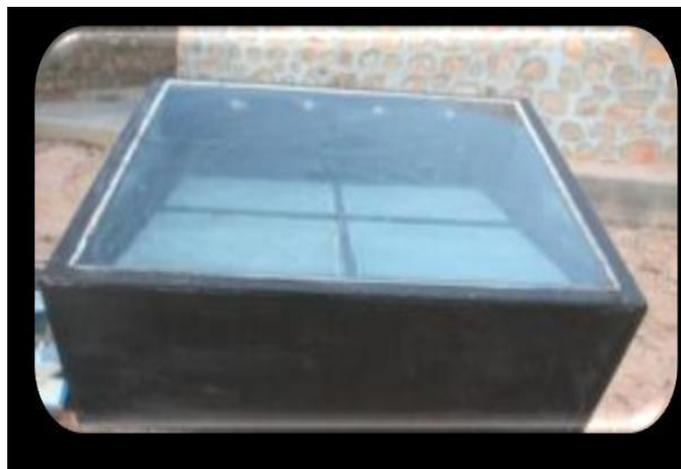
**Figure 2.4.**Séchoir solaire direct
