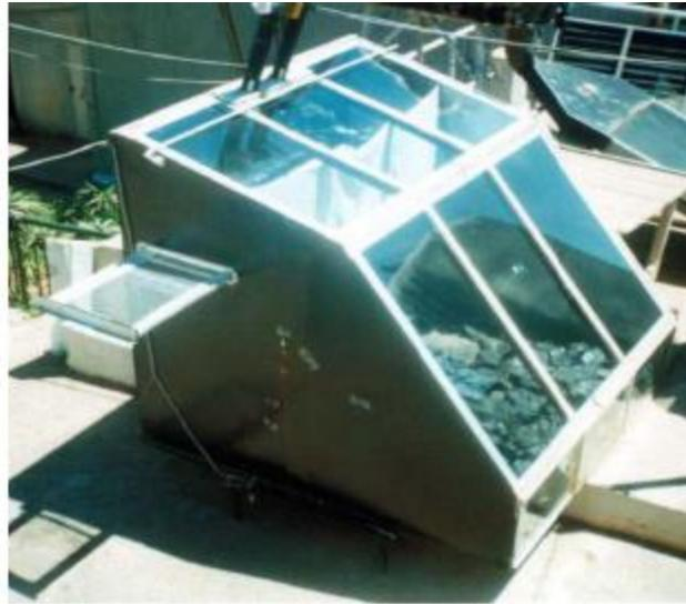
Figure 4.1. Séchoir expérimental
