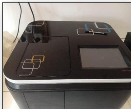
**Figure 25 :** Spectrophotomètre U.V visible
