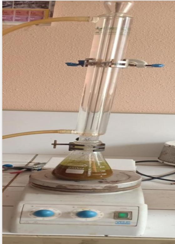
**Figure 20 :** Montage de l'extraction sous reflux (extrait aqueux)
