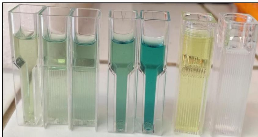
**Figure 26 :** Réduction du fer FRAP de bleu vert au jaune
