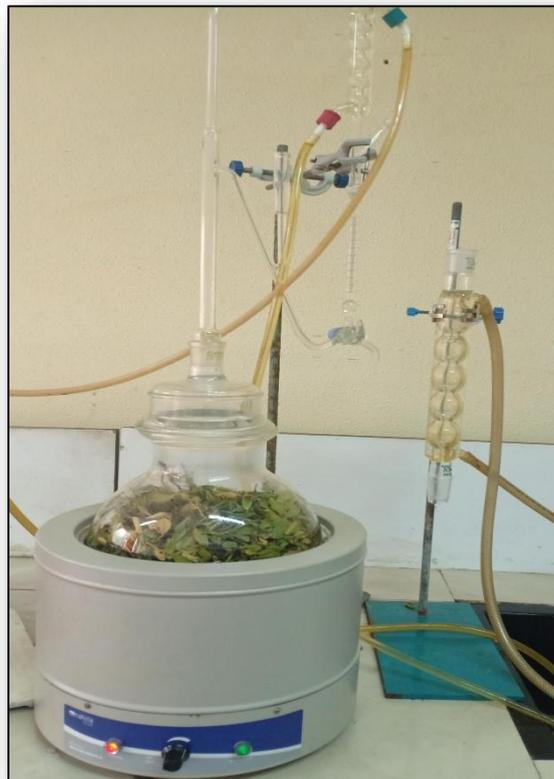
**Figure 22 : Montage d'hydrodistillation (type clevenger)**
