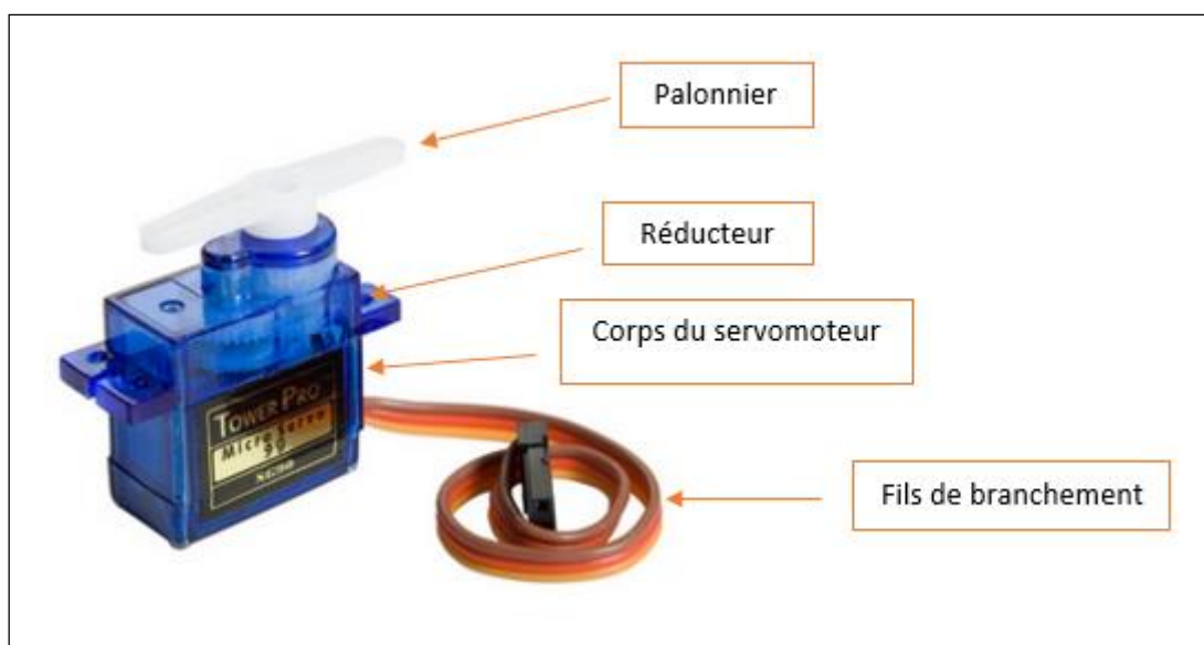
Figure II.8 : Servomoteur SG90.
