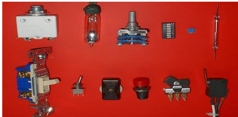
Figure II-14 : Différents types de switch
