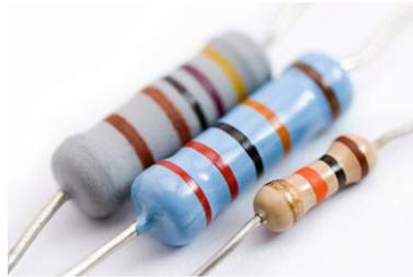
Figure II-3 : Exemple d'une résistance fixe
