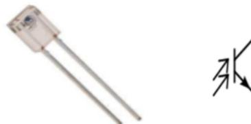
**Figure I-10:** Image et symbole d'un Phototransistor
