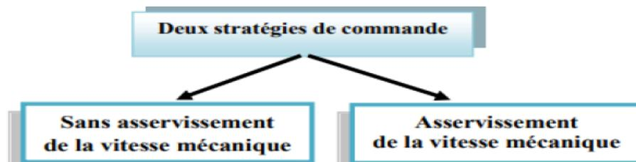
FIGURE II.7 – Stratégies de commande MPPT d'une turbine éolienne
