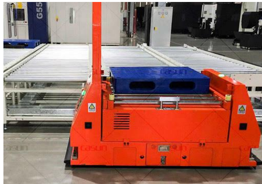
Figure II. 1: AGV à charge unitaire.[26]
