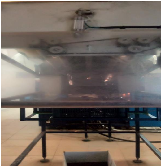
Figure 25: Accumulation de la poussière sur les capteurs la souffleuse
