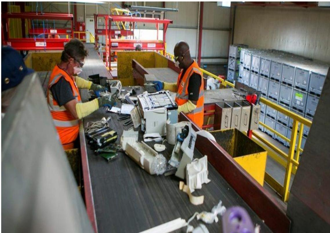
Figure III- 10: démontage et dépolluer les déchets électroniques
