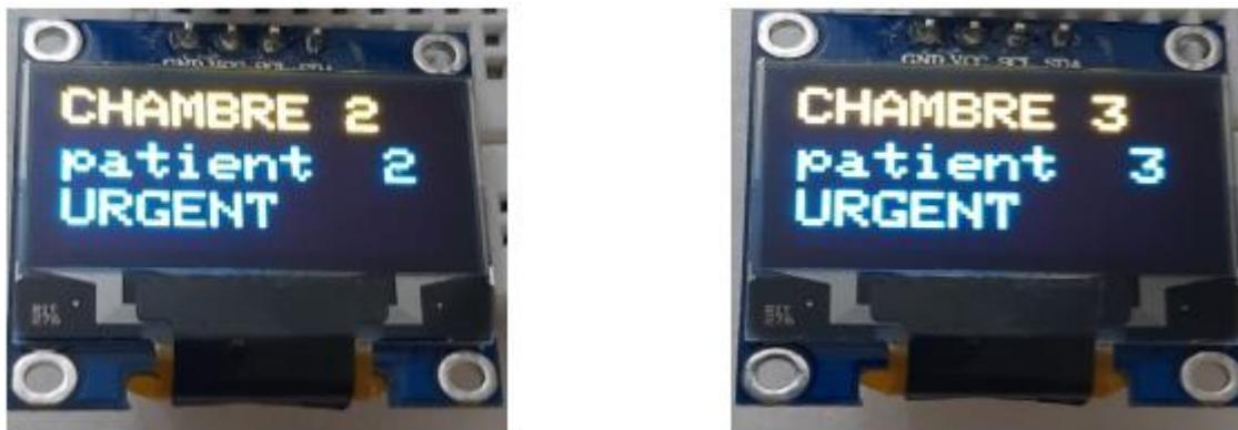
Figure III-21 : Affichage du message d'assistance sur l'écran OLED pour la chambre 2 et la Chambre 3.
