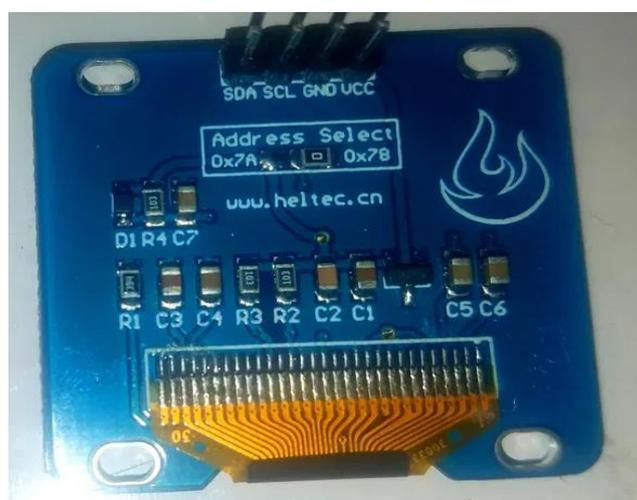
Figure II-12 : Broches de l'afficheur OLED I2C.
