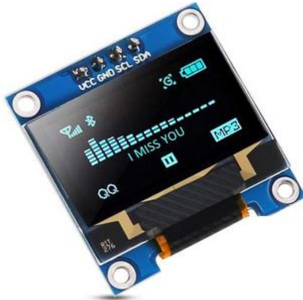
Figure II-11 : Afficheur OLED I2C [36].
