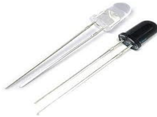
FIGURE IV. 9: led infrarouge avec récepteur [67]
