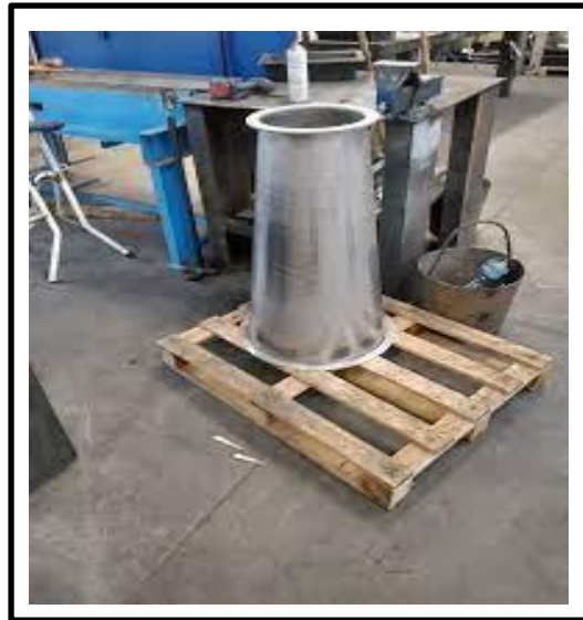
FIGURE I. 23: Tronc de cône et virole en Inox roulées/pointées [25]
