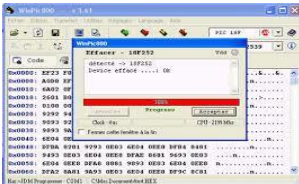
Figure.IV.11. Programmation de PIC par WINPIC 800
