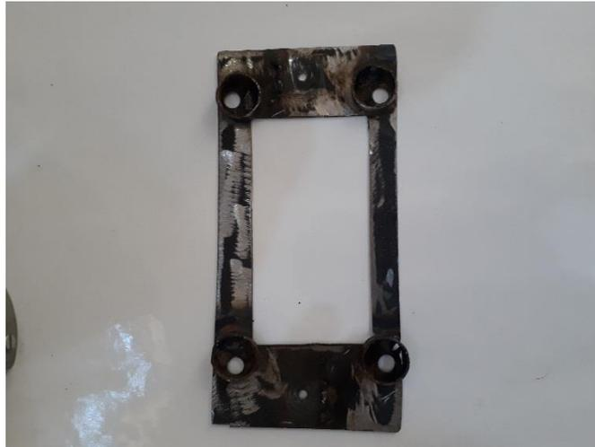
**Figure IV- 53 : Forme de la tôle ajoutée**
