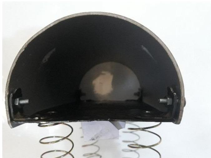
**Figure IV- 52 : Fixation de la tôle avec la pièce de plastique (cabine passager)**
