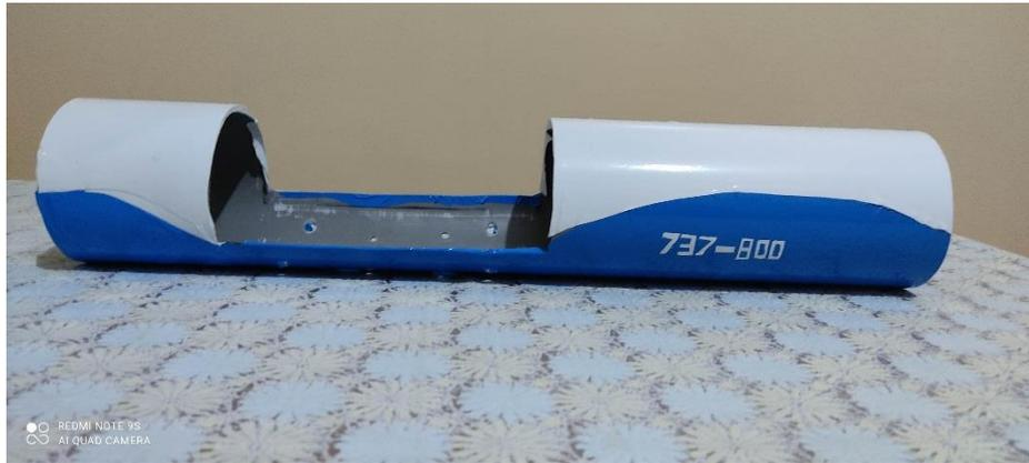
**Figure IV- 65 : Forme finale de fuselage central et l'arrière**
