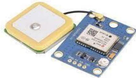
**Figure IV- 77 : Capteur de GPS** (« *Module GPS pour Arduino NEO-6M avec antenne – FABLAB S2T* ». s. d.)
