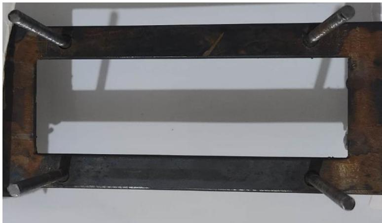
**Figure IV- 45 : Fer à plat cadré (la base) soudé avec les tiges**
