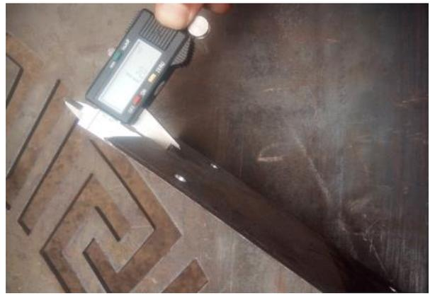
**Figure IV- 46 : Epaisseur de la tôle 1.2 mm**
