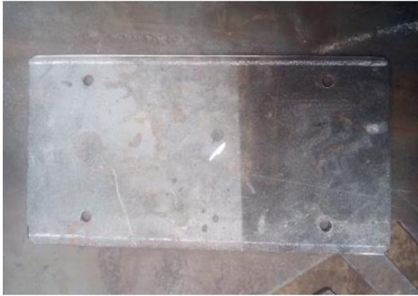
**Figure IV- 47 : Tôle 19.5\*10.5 couper et percer avec un diamètre de 8mm**
