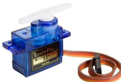
Figure IV- 76 : Servomoteur (Xukyo. 2017.)
