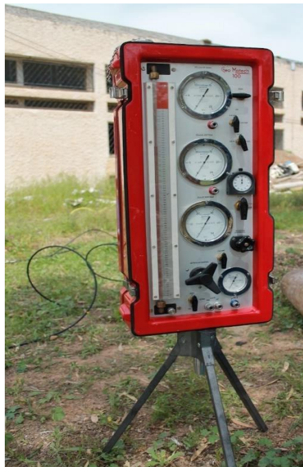
Figure 2. 17 Le contrôleur pression-volume CPV
