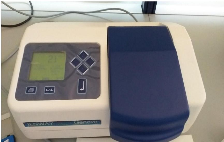
*Figure 3: spectrophotomètre*
