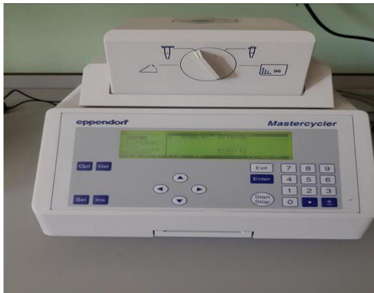
**Figure 4:Appareil de la PCR
