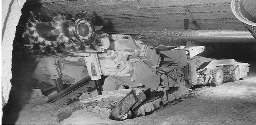
Figure 1.2 Machine d'attaque ponctuelle (Anderson Strathclyde RH25)
