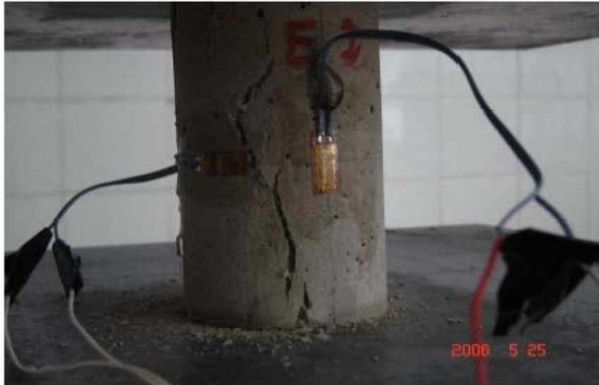
Figure 2.9 : Mode de rupture en compression de l'échantillon cylindrique [82].
