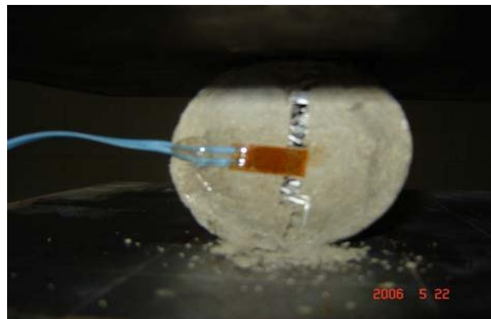
Figure 2.11 : Mode de rupture en traction par fendage [82].
