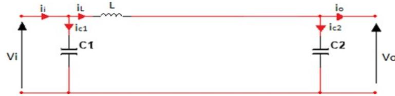
FIGURE II.5 – le schéma équivalent de convertisseur DC – DC de type BOOST l'interrupteur  $K$  est ouvert
