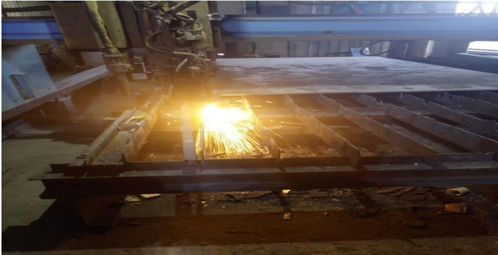
**Figure 29 : Réalisation des coupes par l'oxycoupeur.**
