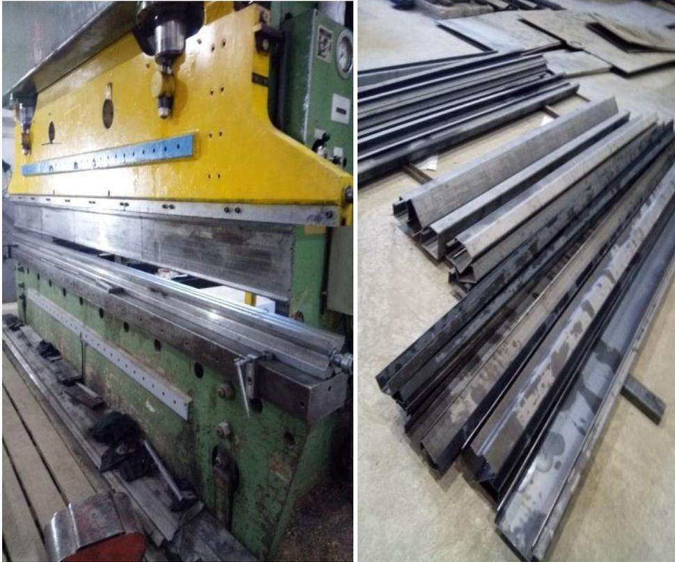
**Figure 32 : Pliage d'une tôle à angle.**
