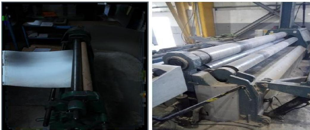
**Figure 31 : Pliage d'une tôle en aluminium.**
