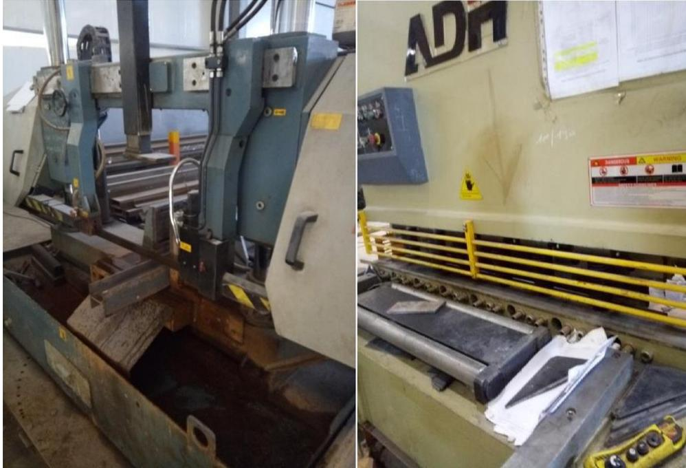
**Figure 30 : Réalisation des coupes par la scie mécanique.**
