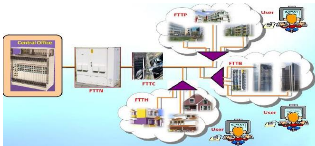
Figure 51: (2.30): Architecture de FTTx qui contient quelques systèmes de réseaux tels que FTTN, FTTC, FTTP, FTTB et FTTH.
