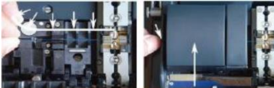
Figure 39: (2.18): Le dépôt des fibres et la fermeture de capot.
