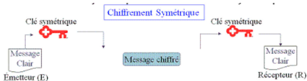
Figure 1.3: La cryptographie symétrique.[5]
