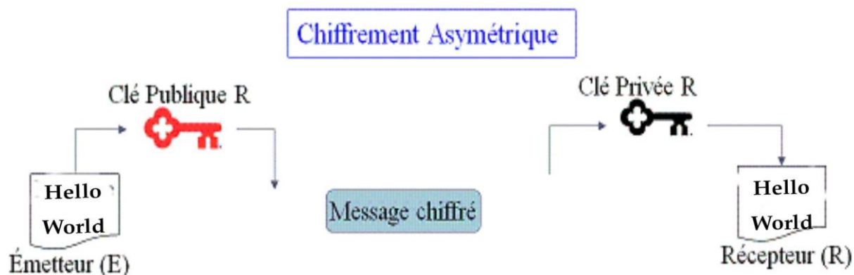
Figure 1.6 : La cryptographie Asymétrique.[5]
