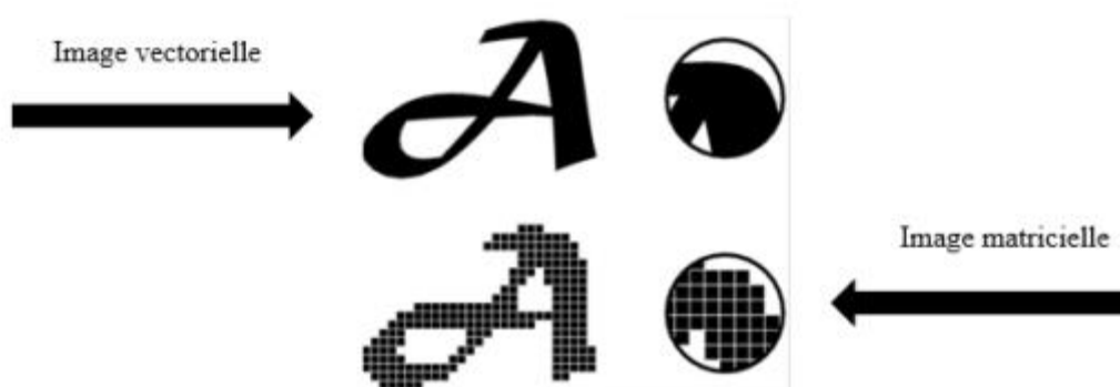
Figure 2.4 : Différence entre image vectorielle et image matricielle[11]
