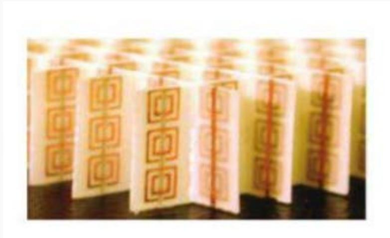
**Figure II. 8: Prototype du métamatériau 2D, les résonateurs en cuivre sont gravés sur un substrat en fibre de verre, les rubans sont gravés sur la face opposée**
