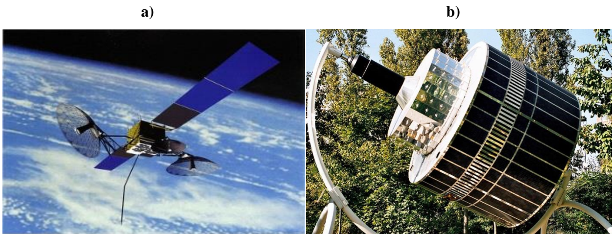
Figure I- 24 : Les réseaux d'antenne a) la deuxième génération de TDRS (GEO) b) METEOLIST de première génération (LEO) [I.26].
