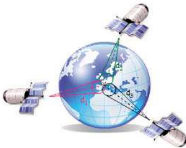
Figure I.2 Principe de la triangulation pour positionner un récepteur à la surface de la terre
