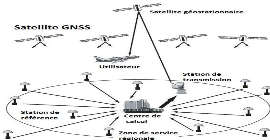
Figure II.2 Architecture générale simplifiée d'un système SBAS
