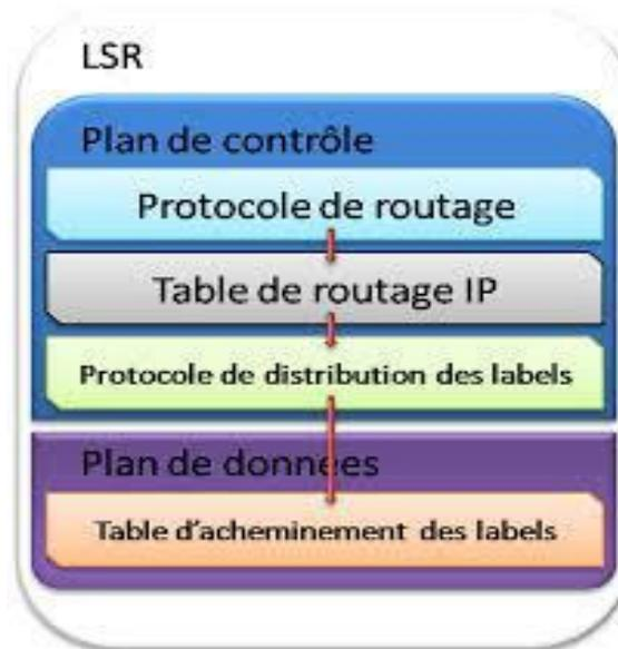
FIGURE 2.3 - Architecture d'un routeur LSR.
