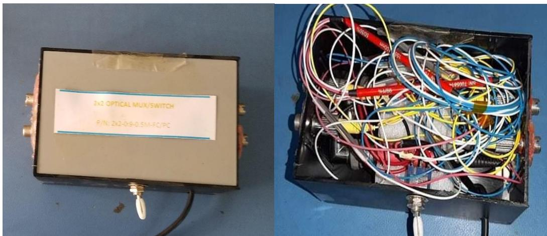
**Figure 82.** Vue du multiplexeur /switch optique 1x2.
