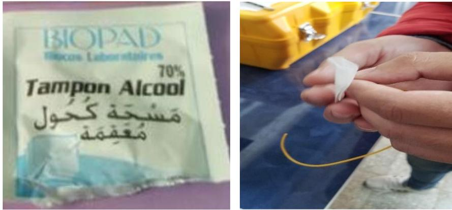
Figure 65. Le nettoyage de la fibre optique.
