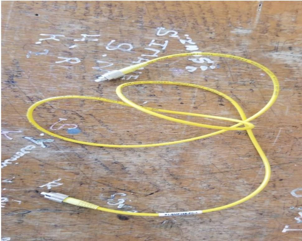
Figure 50. Fibre optique monomode P1-SMF-28E-FC-1 du fabricant Thorlabs. [4].
