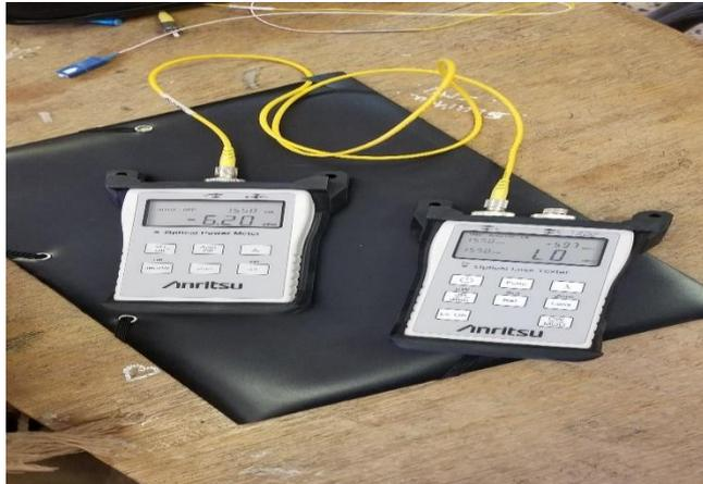
Figure 58.Méthode expérimentale de mesure des pertes optiques d'insertion (FC/PC).
