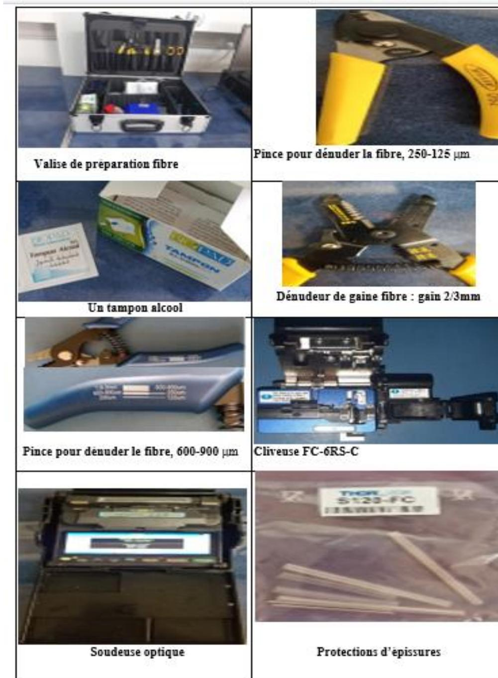
**Figure 63.**Matériel accessoire nécessaire pour opérer à une soudure optique.
