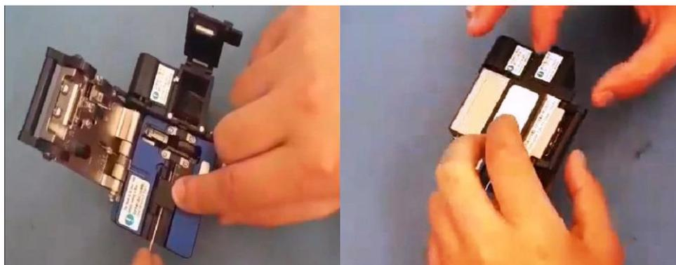
Figure 67. Les étapes de clivage de la fibre optique.
