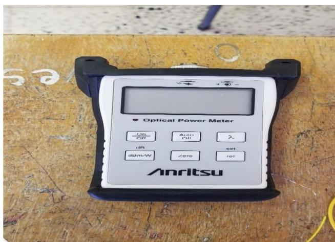
Figure 54.Wattmètre optique (Optical Power Meter). [8]
