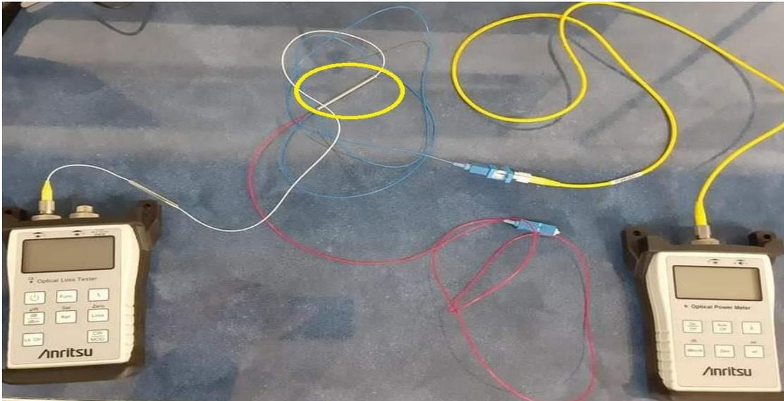
**Figure 79.**Montage de mesure des pertes d'un coupleur optique 50 :50.
